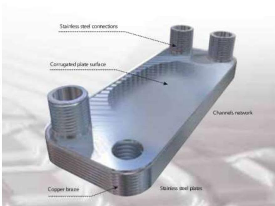
Паяный теплообменник (также известный как ВРНЕ, СВНЕ) состоит из 13 пакетов пластин нержавеющей стали 0.3мм - 0.5мм, которые подвергаются пайке медным припоем. В результате образуется компактный пластинчатый т/о без уплотнений. Принцип работы паяного теплообменника аналогичен пластинчатому, но ввиду отсутствия уплотнений т/о данного типа могут работать при температуре 200 С и давления в пределах 30 бар, что обеспечивает работоспособность при высоких температурах и давлениях.
