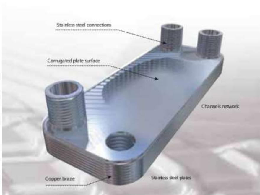
Паяный теплообменник (также известный как ВРНЕ, СВНЕ) состоит из 13 пакетов пластин нержавеющей стали 0.3мм - 0.5мм, которые подвергаются пайке медным припоем. В результате образуется компактный пластинчатый т/о без уплотнений. Принцип работы паяного теплообменника аналогичен пластинчатому, но ввиду отсутствия уплотнений т/о данного типа может работать при температуре 200 С и давления в пределах 30 бар, что обеспечивает работоспособность при высоких температурах и давлениях.
